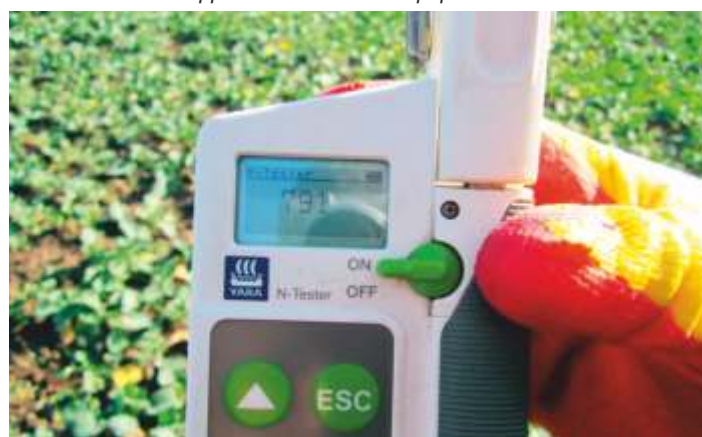
Измерение интенсивности окраски листьев прибором N-тестер в ООО «Кампоферма» Московской области
