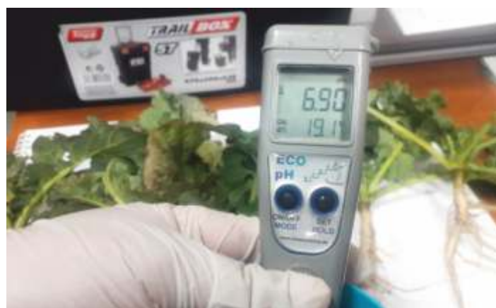
Определение pH и ЕС почвенного раствора в слое 0–20 см в ООО «Кампоферма» Московской области
